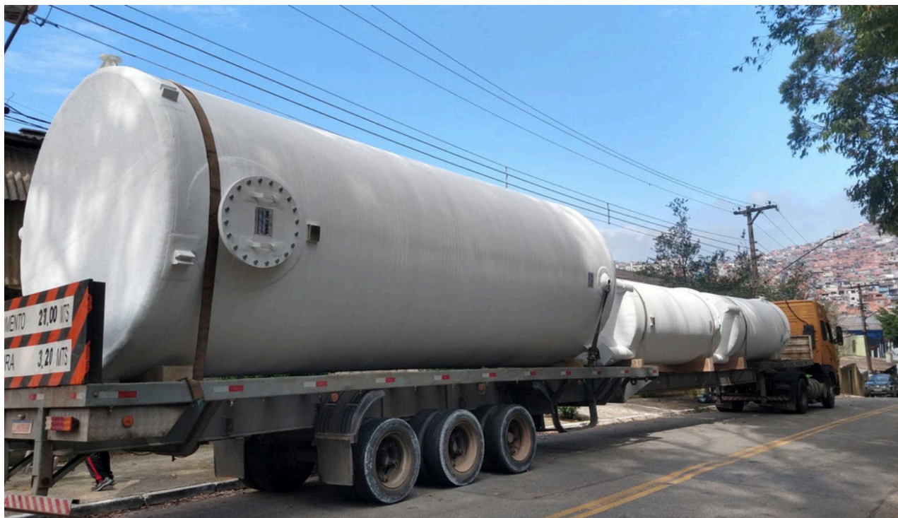
FOTO 2: Berços garantindo o armazenamento seguro de tanques durante o transporte
