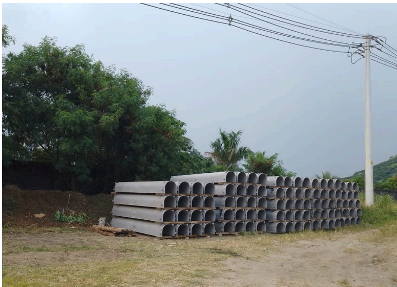
FOTO X: Peças armazenadas ao tempo por vários meses e mantidas as condições do plano de embalagem.
