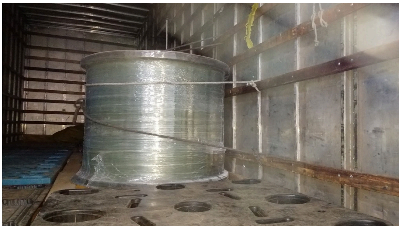
FOTO XXX: Reator com flanges protegidos por papelão e plástico filme e ressalto com acesso protegido
