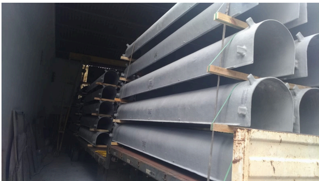
FOTO X: Sustentação da carga por meio de pontaletes e sua amarração com fita de PVC e clips
