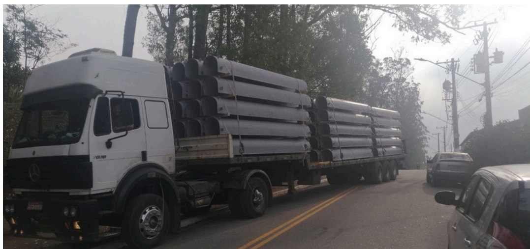
FOTO X: Empilhamento máximo de 5 alturas e travamento na estrutura do caminhão feito por cintas
