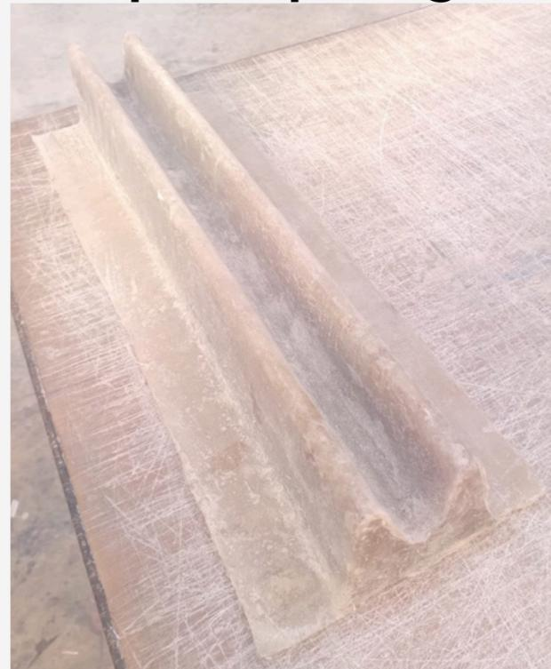
**Sapata para tanques de fundo cônico**
